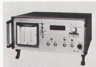
An der Swissbau in praxisnahem Einsatz zu sehen: der ProvalK-Tester mit Digitalanzeige und eingebautem Schreiber
