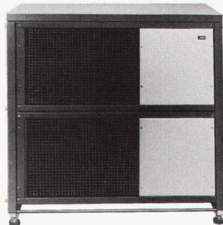
Die AEG Wärmepumpe besteht aus zwei Wärmetauschern und einem geschlossenen Kältekreislauf. Darin wird die Aussenluft auf eine höhere Temperatur hochgepumpt und diese Wärme ans Heizungswasser abgegeben. Dank der neuartigen Modulbauweise kann die Heizleistung dem jeweiligen Wärmebedarf individuell
