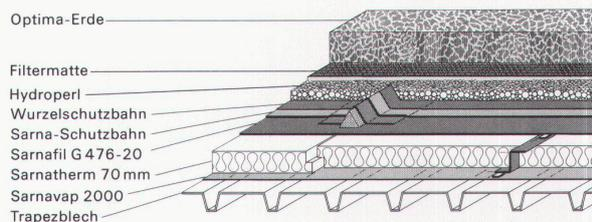
Schichtaufbau des begrüntes Jumbo-Flachdaches mit optima-System.
