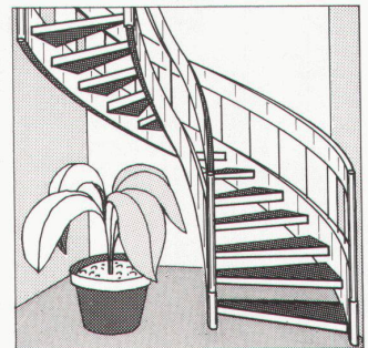
Neu: Die halbgewendelte Formsperrholztreppe überwindet Stockwerke auf kleinstem Raum.
