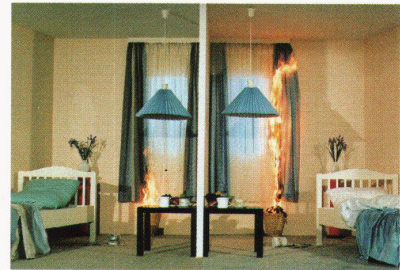
In der Brandversuchsanlage der Hoechst AG können ganze Wohnungsbrände simuliert werden. Im direkten Vergleich werden hier herkömmliche Textilien gegen TREVIRA CS getestet. Zunächst fangen beide Textilien Feuer, TREVIRA CS bereits deutlich geringer.
