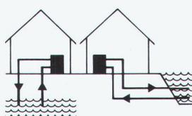
Bei vorhandenem Grund- oder Oberflächenwasser wird in einem Kreislauf dem Wasser Wärme entzogen. Pro Kubikmeter Wasser ca. 20 000 kJ (5000 kcal) Nutzwärme.
