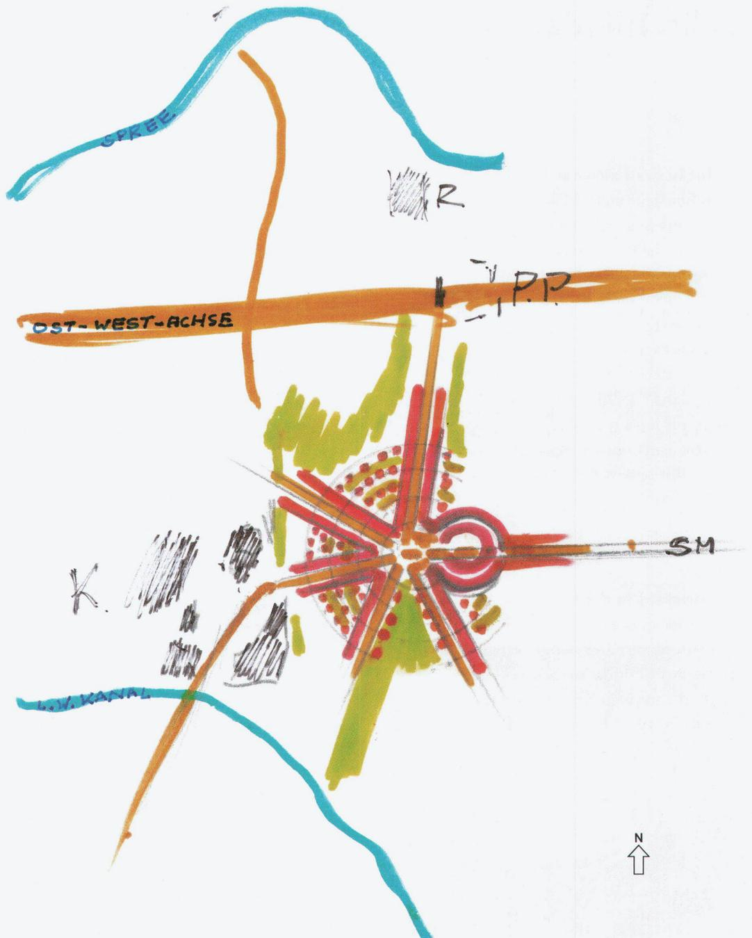
Skizze des Situationsplans und Querschnitt durch den Strassenraum. Die sternförmig verlaufenden Hauptstrassen sind leicht ansteigend, um den Potsdamer Platz topographisch zu akzentuieren. Die Strasse selbst schlüsselt den Verkehr in verschiedene Träger und Geschwindigkeiten auf.
