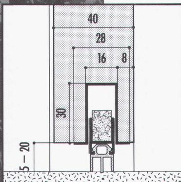
Schwellose Türverschlüsse von Planet schützen vor Wärmeverlust und Zugluft (Modell A3), vor Schall, Nässe und Rauch. Ausserdem werden damit Räume rollstuhlgängig. Schwellose Türverschlüsse von Planet können einfach in jede Tür eingebaut werden. Auch nachträglich. Anruf genügt. Wir rufen zurück.
