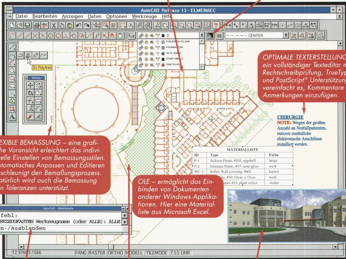
**FLEXIBLE BEMASSUNG** – eine grafische Voransicht erleichtert das individuelle Einstellen von Bemessungsstilen. Automatisches Anpassen und Editieren beschleunigt den Bemessungsprozess. Natürlich wird auch die Bemessung von Toleranzen unterstützt.
