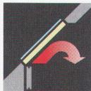
VELUX THERMO-STAR Isolierglasscheiben sind gasgefüllt, zweifach versiegelt und haben einen K-Wert von  $1.3 \text{ W/m}^2\text{K}$ . Das innere Glas ist mit einer Edelmetallbeschichtung versehen. Das äussere Glas (ESG) ist gehärtet und bietet einen 99 prozentigen Hagelschutz.
