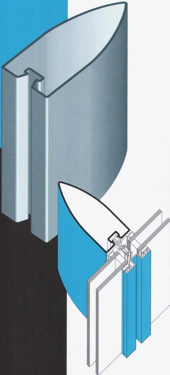
Das Design der schlanken Profilform verleiht Fassaden und Lichtdächern eine dynamische, transparente Erscheinung. Mehr Tageslicht durchflutet Innenräume. Ästhetik und Funktionalität sind vereint. VISS®-Delta weist gute statische Eigenschaften auf, ist in Schweiß- oder Steckbauweise aufbaubar und kombinierbar mit unseren bewährten VISS-Profilsystemen. Die äusseren Abdeckprofile sind in verschiedenen Tiefen und Konturen in Alu, zum Teil auch in INOX oder Baubronze, erhältlich.
