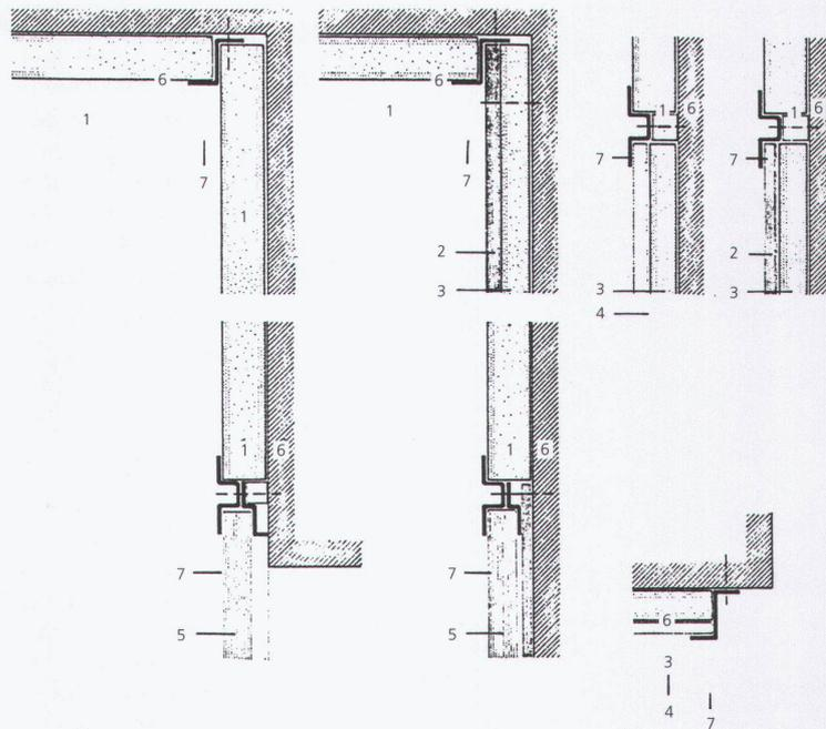
Detail der vorfabrizierten Innenwände aus Spanplatten, die mit Messingwinkelprofilen verbunden sind:
