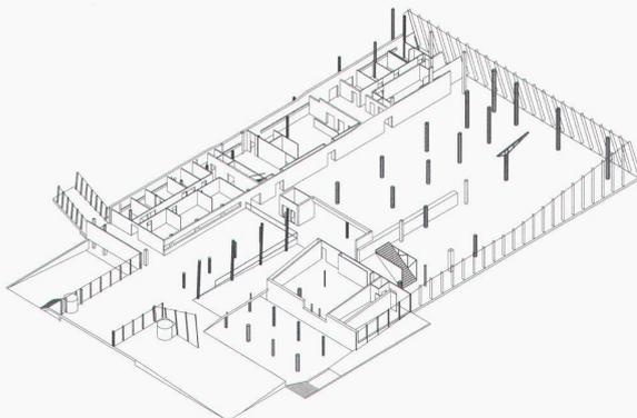
**Die Stützen in den Examensälen sind verbunden zu geschosshohen Vierendeelträgern. Dadurch konnte im darunterliegenden Eingangsgeschoss ein grosser Teil der Stützen weggelassen werden. Die Rampen wirken als aussteifende Elemente. Die Auskragung der Ostfassade wird durch im Gebäudeinnern unsichtbare Überzüge auf dem Dach gehalten.**
