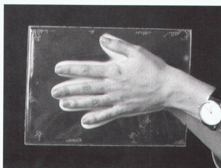
Integration von thermotropen Schichten: Experiment über Streuverhalten unter Wärmeinfluss
