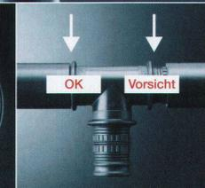
Geberit Mepla Sichtbar Sicher setzt jetzt den neuen Standard mit der 3-fachen Prüfsicherheit. Die silberne Markierung auf jedem Fitting gibt Sichtbar Sichere Sicherheit. Jede nicht verpresste Verbindung wird bei der Dichtheitsprüfung mit Wasser bereits bei 1 bar Prüfdruck Sichtbar Sicher erkannt.
