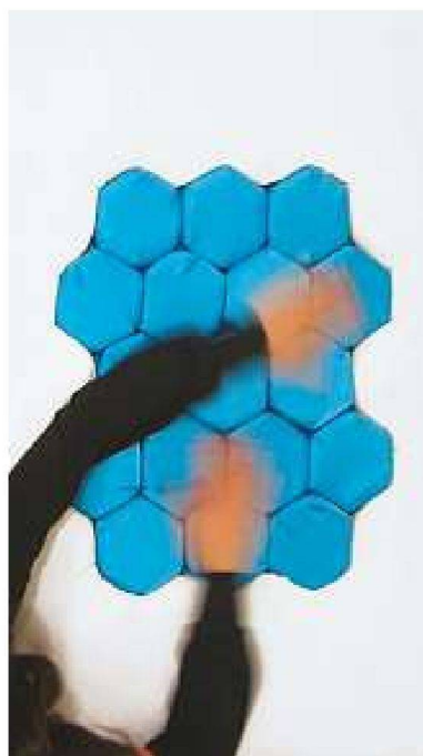
Projekt Sensitive Voxel: Prototyp eines multi-dimensionalen Tastrasters aus identischen Zellen, die mit Wärme, Kälte und Vibration auf unseren Tastsinn wirken können. Die Wirkung der darauf abspielbaren Muster ist verblüffend. Welche neuartigen Interaktions- und Kommunikationsformen sich mit solchen, sich überlagernden Mustern eröffnen, und ob neben therapeutischen auch Anwendungen im Bereich der interaktiven Architektur sinnvoll sind, soll nun mit einem interdisziplinären Forschungsprojekt untersucht werden. – Bild: I. Pohl
