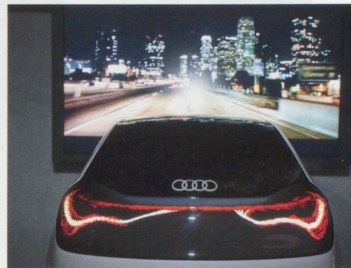
OLED-Rückleuchte in einer Konzeptstudie von Audi
