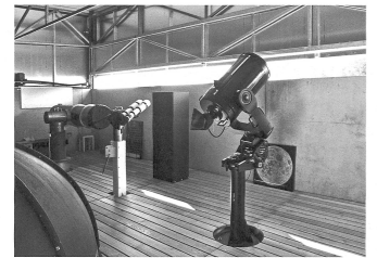
Die beiden Hauptteleskope verfügen über unabhängige Fundamente
