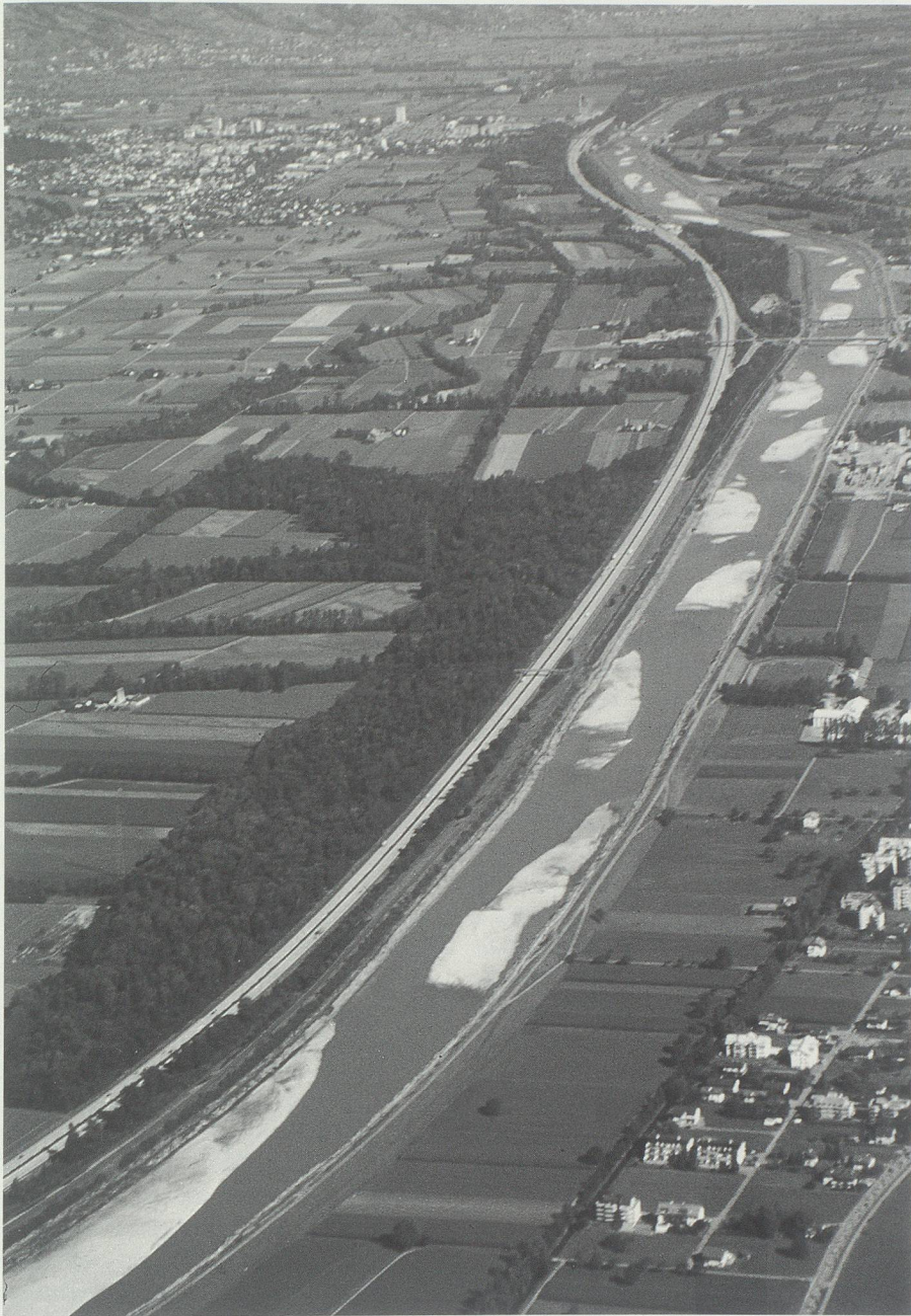
Der Rhein mit alternierenden Kiesbänken im Abschnitt Balzers (rechts unten) bis Buchs (links oben).
