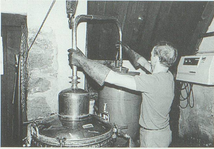
Nach Beigabe von Wasser werden Deckel und Destillationsrohr aufgesetzt.
