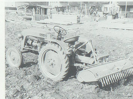
Bucher-Traktor mit zapfwellengetriebener Bodenfräse. Bild im Archiv Landwirtschaftliche Schule Rheinhof, Salez.
