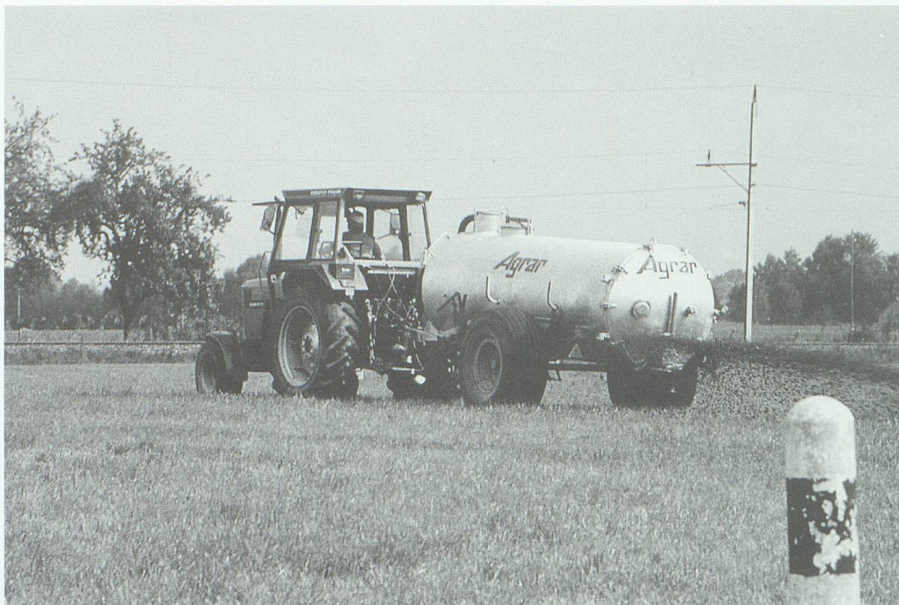
Abb. 4. Das neue Aufstallungssystem mit Schwemmentmistung bringt aus der Rindviehhaltung anstatt Mist und Harngülle nur noch Vollgülle. Mit dieser Rationalisierung veränderte sich auch die Gülleausbringtechnik. Zapfwellenbetriebene Druckfässer haben eine grosse Leistungsfähigkeit.
