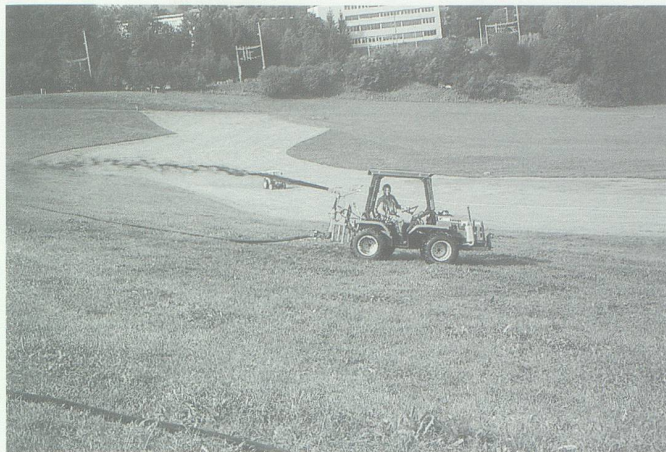
Abb. 5. Die mechanisierte Gülleverschlauung bietet heute für arrondierte Betriebe oder hofnahe Parzellen eine Ausbringtechnik für Gülle, die sich durch hohe Leistung und Bodenschonung auszeichnet: Die Böden müssen nicht mit schweren Druckfässern befahren werden.
