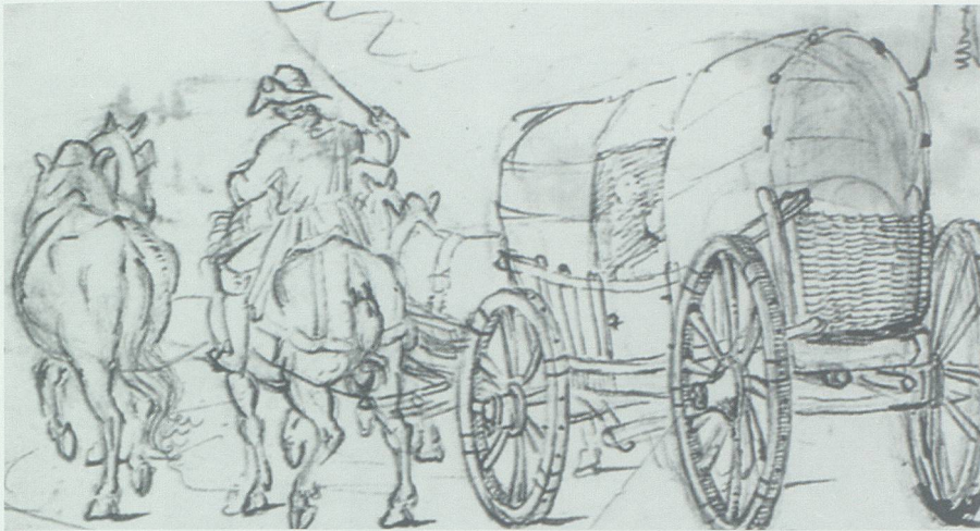
Reisewagen im 17. Jahrhundert: Geflochtener Wagenkorb mit Blache, die über gebogene Weidenruten gespannt ist. Aus Treichler 1991.
