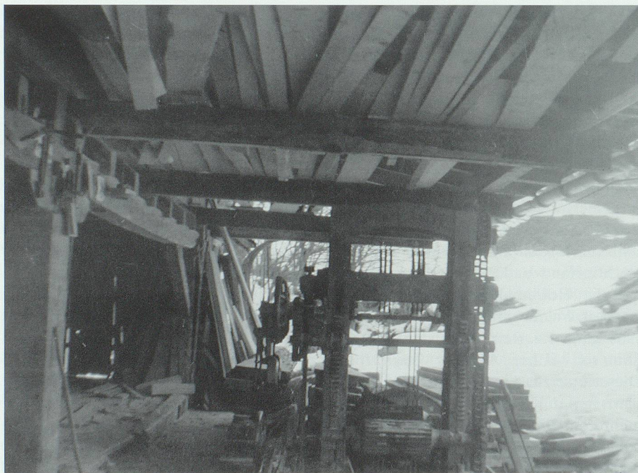
Blick auf den Vollgatter in der Sägerei auf dem Lehn am Grabserberg. Aufnahme aus den 1970er Jahren, in Privatbesitz.
