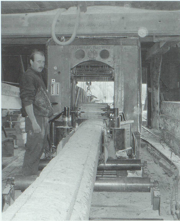
Eine der letzten als Vollerwerb betriebenen Werdenberger Sägereien ist die Sägerei Friedrich Göldi in Sennwald. Im Bild links das Vollgattersägewerk, rechts die Zuführung der Stämme auf die Säge. Bilder: Hans Jakob Reich, Salez.
