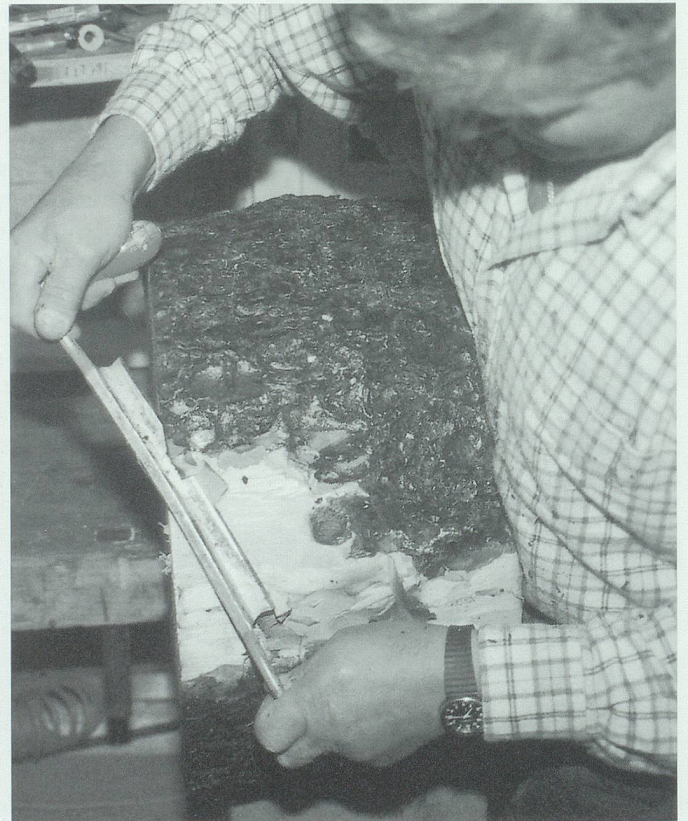
Mit dem Schälmesser wird die Rinde abgezogen.
