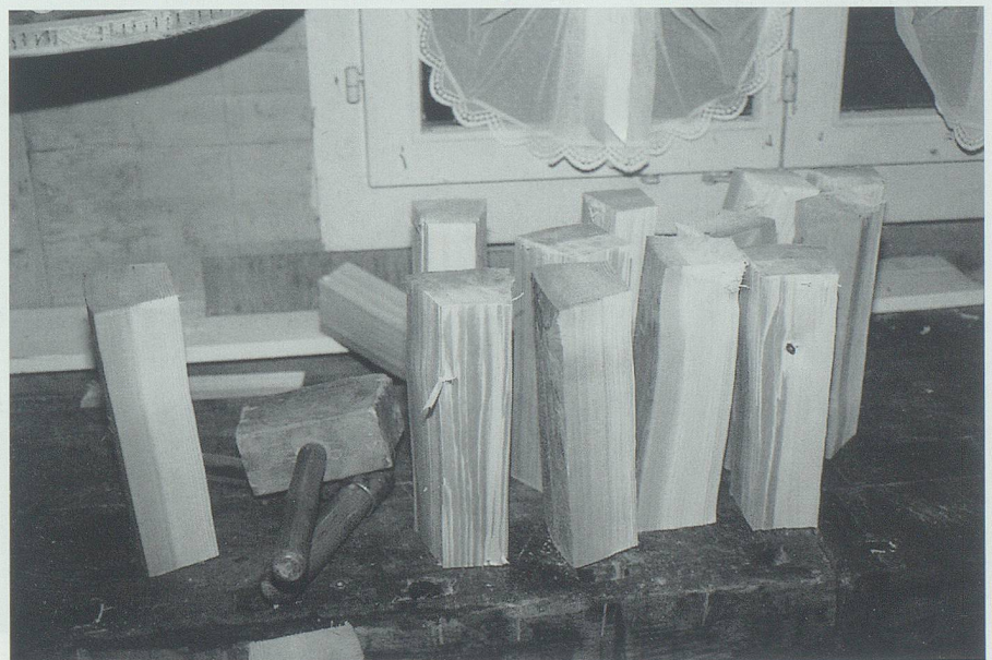
Die Möseln für die Schindelherstellung sind bereit gemacht.
