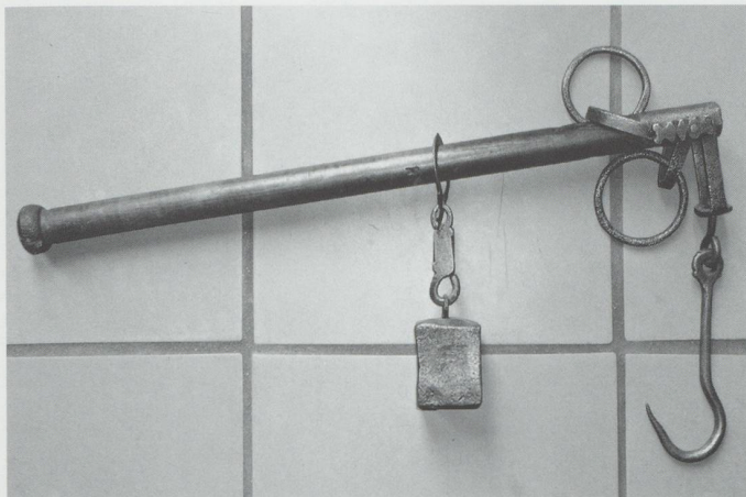
Eine Schnell- bzw. Stangenwaage aus der Herrschaft Sax-Forstegg (Salez); gezeichnet mit «1773 VR» (vmtl. Ulrich Reich). Sammlung Hans Jakob Reich, Salez.
