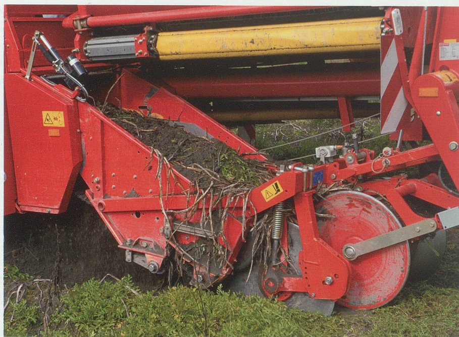
Fast so sorgfältig wie von Hand, aber bedeutend schneller hebt der Kartoffelroder – hier eine einreihige Maschine – die Ernte aus dem Boden. Foto Hans Jakob Reich, Salez
