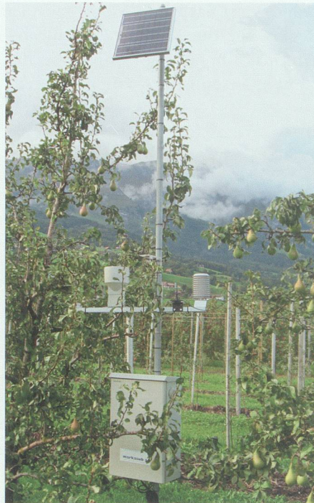
In der Wetterstation Grabs werden täglich die Wetterdaten erfasst. Sie werden an der Forschungsanstalt in Wädenswil ausgewertet. Auf diese Weise wird während der Kernobstblüte die Blüteninfektionsgefahr ermittelt.
