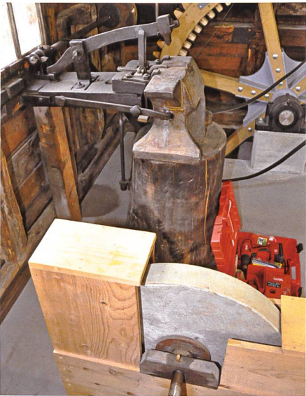
26. September 2013: Der neue Sand-schleifstein mit Bock steht neben dem mechanischen Dengelhammer.
