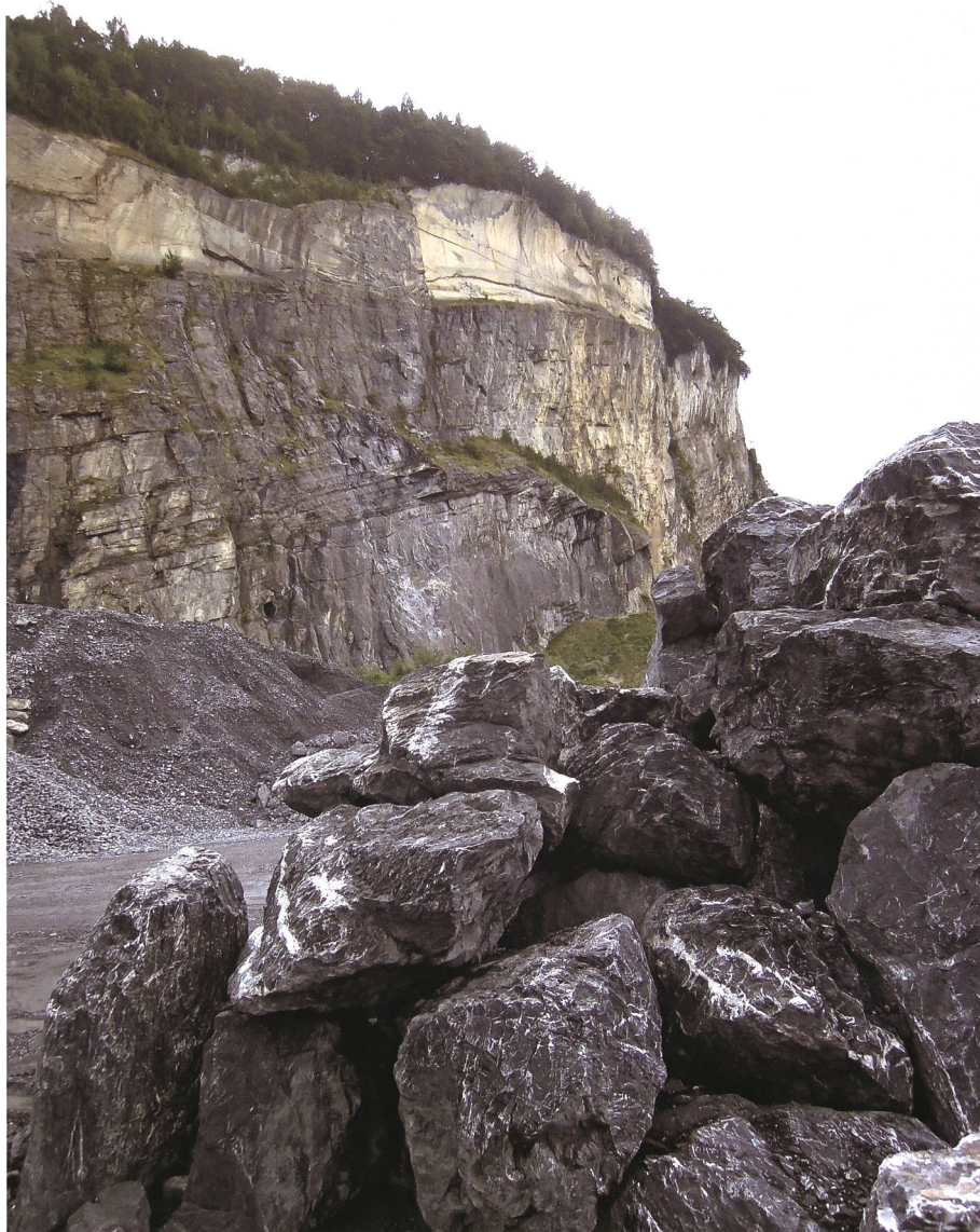
Abb. 16. Quintner Kalk wird als «Balzner Marmor» abgebaut. Charakteristisch ist seine dunkle bis fast schwarze Farbe mit den weissen Kalzitadern. Die schwarze Farbe stammt von organischen Überresten, also Resten von Lebewesen. Die weissen Kalzitadern entstanden später im Zug der Gebirgsbildung durch die Ausfällung von reinem Kalk (Kalzit) in Spannungsrissen.
