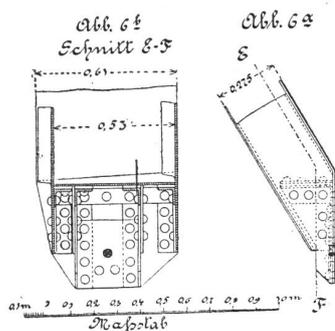
machen, dass infolge der aus Abbildung 1b (Schnitt a-b) deutlich ersichtlichen leichten Verdrehung der die Abschlusswand bildenden Deckbleche der Böcke gegen eine zur Richtung der Wehraxe parallele Ebene im aufgestellten Zustande der Böcke ein mässiges Übergreifen der Deckbleche stattfindet, das die Dichtigkeit des Wehres erhöht. Diese Abdichtung der Stauwand kann je nach Wunsch am vordern oder hintern Bockschenkel oder an beiden derselben vorgesehen werden.
