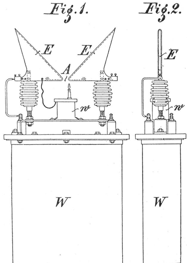
Die Figur 1 zeigt die Vorder-, die Figur 2 die Seitenansicht einer beispielsweise Ausführung der Vorrichtung. Die kastenförmigen Hörner sind mit *E* bezeichnet, sie können aus Blech oder Guss hergestellt sein. Der Abstand zwischen ihnen, das ist die Funkenstrecke, ist mit *A* be-
