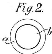
Das allen Unebenheiten der Kontaktflächen der Leiter bei Zusammenpressung derselben sich anschmiegende Metallpulver verursacht eine gute Stromüberleitung zwischen den beiden Leitern.
