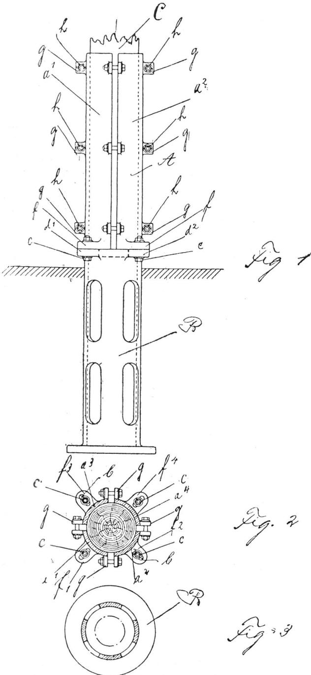
Sockel ausgebildet ist, während der Oberteil aus mehreren, mittelst durch Verbindungslappen gehenden Schrauben miteinander verbundenen Schienen besteht, und wobei die die Trennungsf lächen aufweisenden Enden beider Teile zwecks ihrer Verbindung mit zentrisch gerichteten, einen Schlitz aufweisenden Verbindungslappen versehen sind derart, dass die
