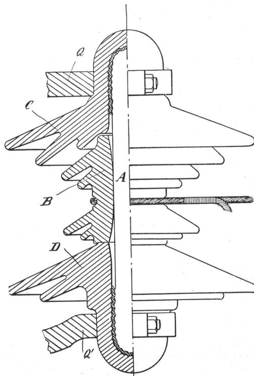
Sur l'âme en métal A, qui consiste en une barre cylindrique pourvue d'un tauraudage aux deux extrémités, est enfilé le noyau B en matière isolante destiné à retenir le conducteur ou câble électrique.
