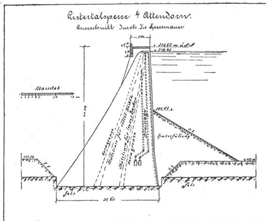
Das Niederschlagsgebiet der Listertalsperre beträgt 66,8 km<sup>2</sup> bei einer mittleren jährlichen Zuflussmenge von 54 Millionen m<sup>3</sup>. Bei vollem Staubecken wird eine Bodenfläche von 168 ha überstaut und es beträgt die grösste Länge des zukünftigen Stausees reichlich 5 km. Die Sperrmauer erhält die gekrümmte Form einer Parabel und wird ganz aus Bruchsteinen in Trassmörtel von der Zusammensetzung: 1 Teil Kalk, 1¼ Teil Trass und 2¼ Teil Sand erbaut werden. Die
