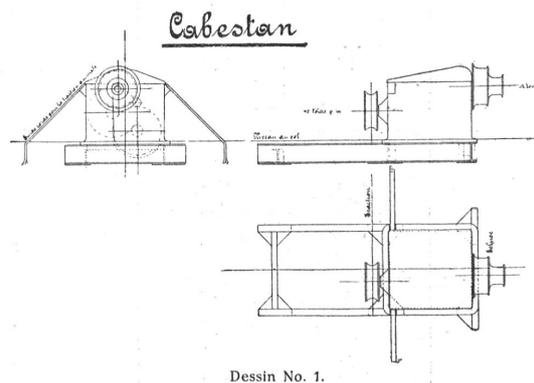
et composés chacun d'une caisse en fonte renfermant l'électromoteur à courant triphasé, avec rotor en court circuit et à grand glissement, capable de produire sur son arbre une puissance de 7 chevaux vapeur en tournant à 1100 tours à la minute sous une tension de 500 volts. Il commande au moyen d'engrenages deux arbres sortant tous les deux de la caisse, l'un dans le sens opposé de l'autre et supportant: l'un une poupée double à deux diamètres différents, l'autre une poupée simple.
