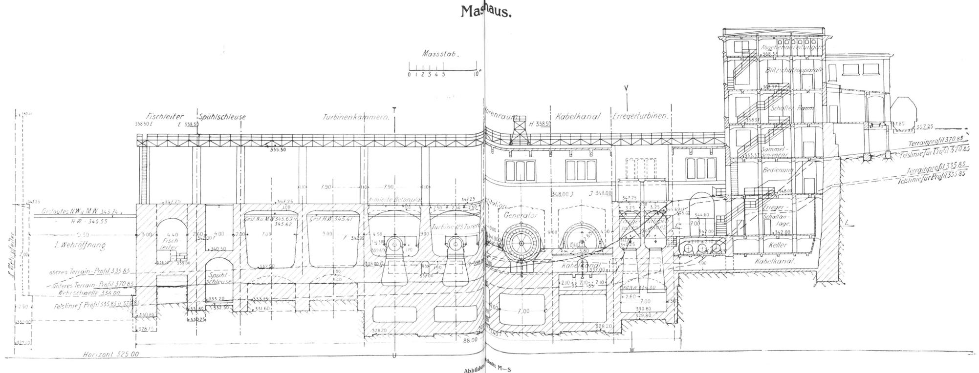
des Schwemmgutes an den Rechen ausgeschlossen ist. Die Einlaufmauer wird den Rechenfeldern entsprechend in Entfernungen von je 6,0 m auf die Molasse mit Senkbrunnen fundiert. Zur bessern Führung des Wassers werden die Tragböcke mit Eisenbeton verschalt.
