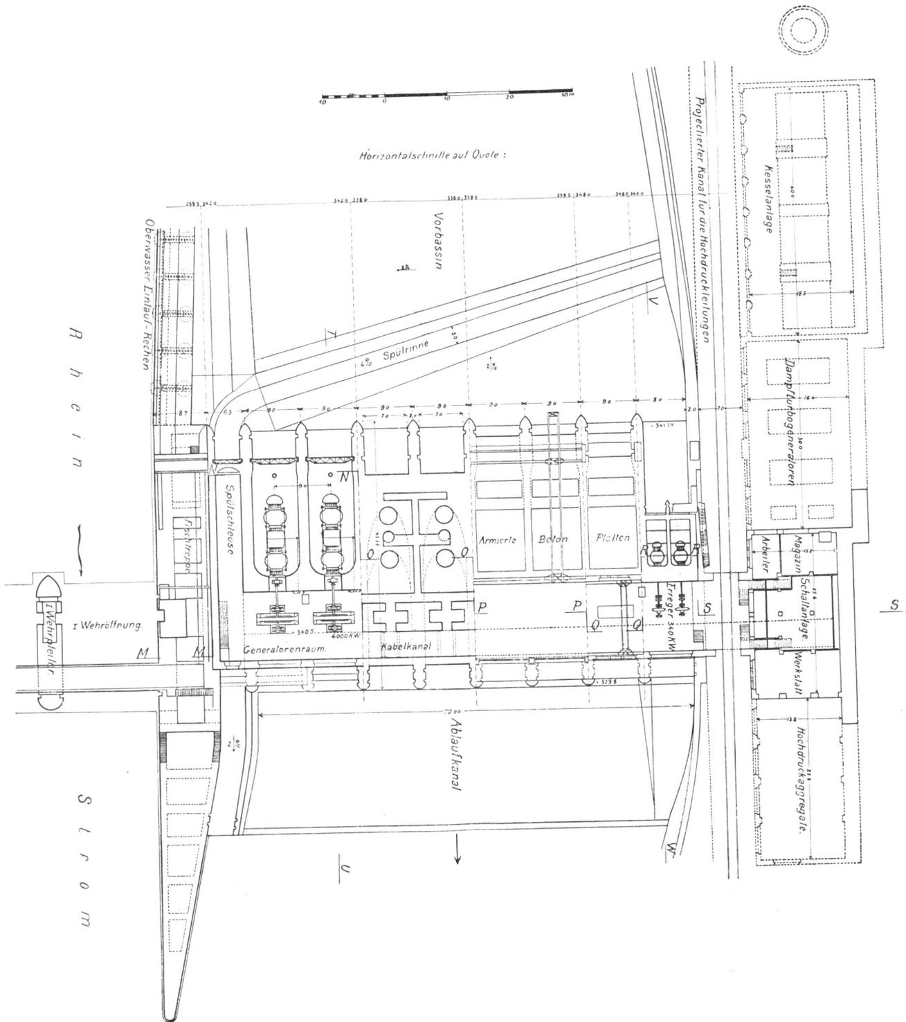
Abbildung 13. Grundriss E—L des Maschinenhauses für Niederdruck, Hochdruck und Dampfreserve.
