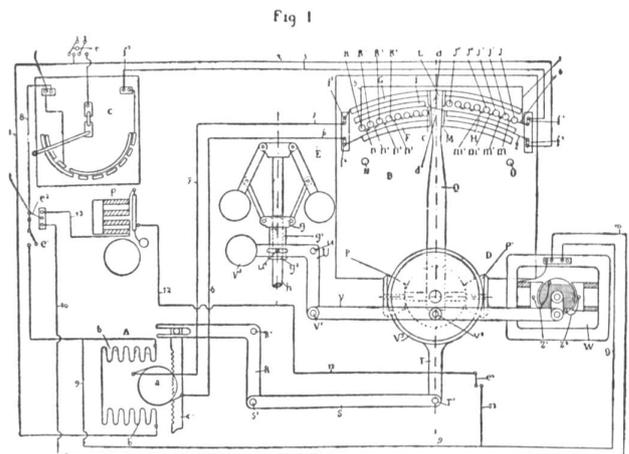
la ligne moyenne vers la droite, mais alors le courant se renverse dans le servo-moteur qui, en conséquence fait descendre la vanne d'où diminution de  $\delta$ , donc de  $\beta$  et le bras Q revient vers sa position moyenne.
