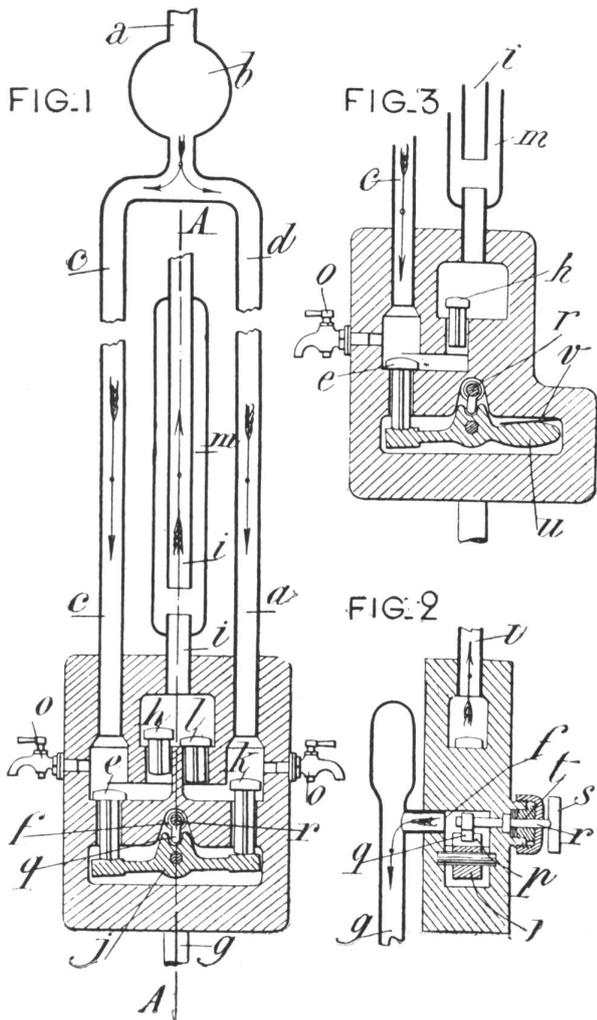
Dans la deuxième forme d'exécution (fig. 3) il n'y a qu'une seule soupape *e* commandant le passage du liquide de la conduite *c* dans la chambre inférieure et reposant sur l'un des bras du balancier *u* dont l'autre bras a une masse suffisante pour jouer le rôle de contrepoids; sur ce dernier bras agit un ressort *v* dont la tension varie suivant la position de la soupape *e* et qui conjointement avec le contrepoids produit la force variable pouvant produire l'ouverture de la soupape.
