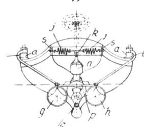
Die Schwimmer werden genügend weit vom Schiffskörper gehalten, so dass sie die Verstellung des Steuers in keiner Weise verhindern. Durch Lösen der Stangen *c* und der Federn *s* vom Boot wird der Motor vom Boot losgelöst.
