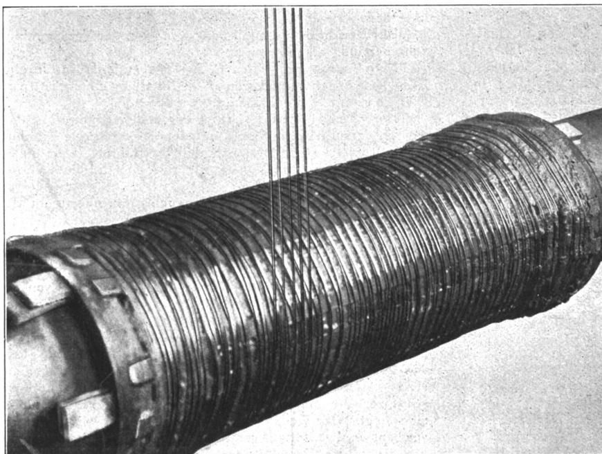
Abbildung 4. Aufschnürung der Querarmierung auf den Schalkörper.
