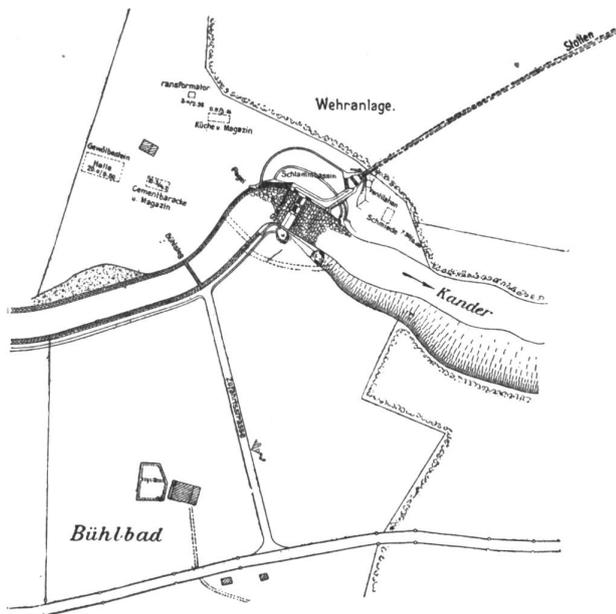
Abbildung 2. Übersichtsplan der Wehranlage und Wasserfassung.
