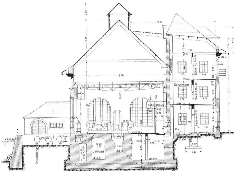
Abbildung 9. Elektrizitätswerk Kandergrund. Querschnitt durch die Zentrale. Maßstab 1:300.
