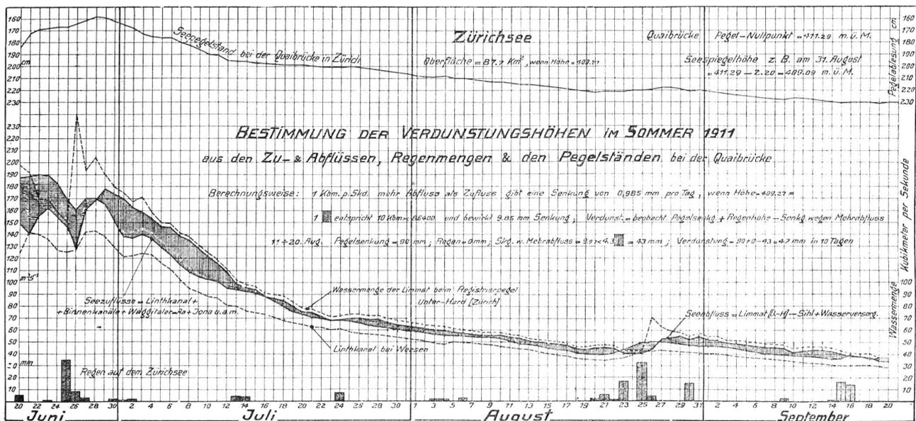
Fig. 2. Bestimmung der Verdunstungshöhen im Sommer 1911 auf dem Zürichsee.
