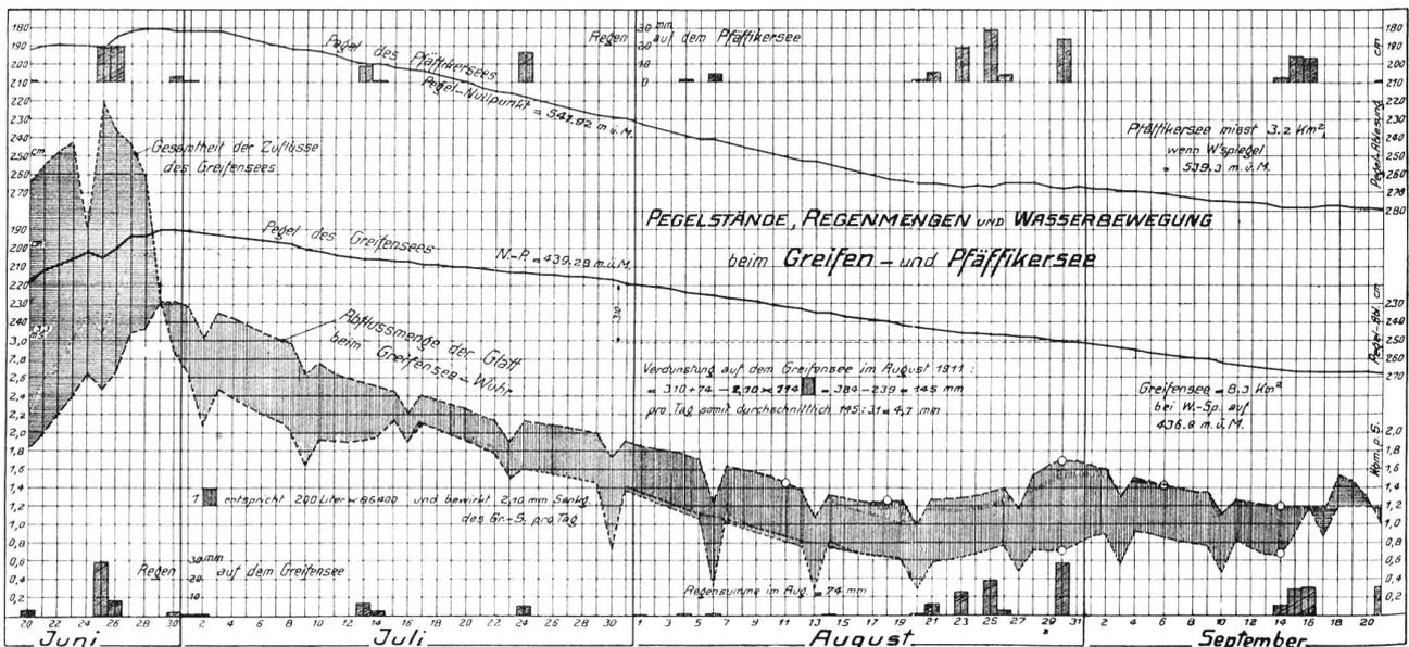
Fig. 4. Pegelstände, Regenmengen und Wasserbewegung beim Greifen- und Pfäffikersee.
