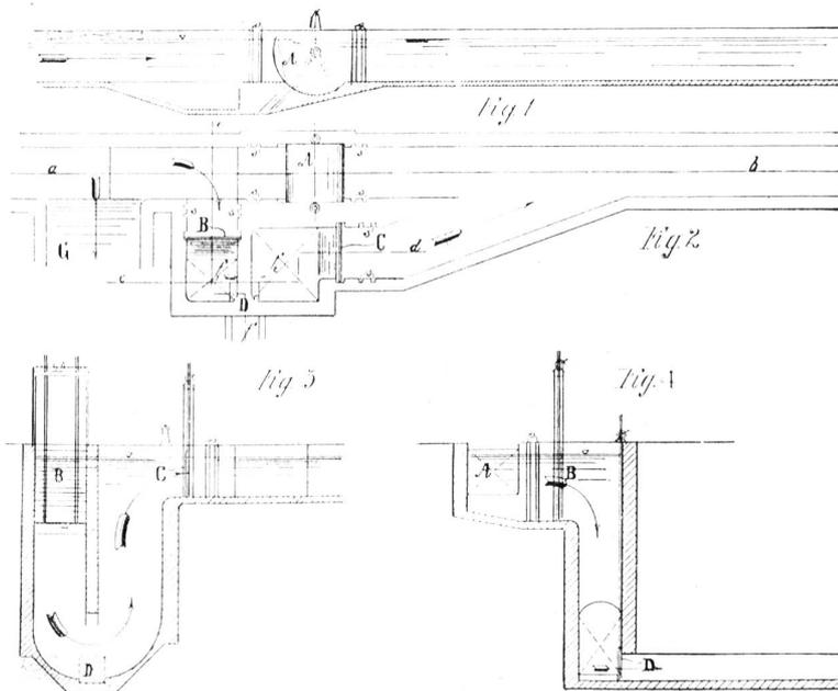
Wasser jedoch in den Düker eintreten kann. Bei offenem Schieber *D* werden die Sinkstoffe, die sich am Boden des Dükers ablagern, durch den Spülauslass gespült.
