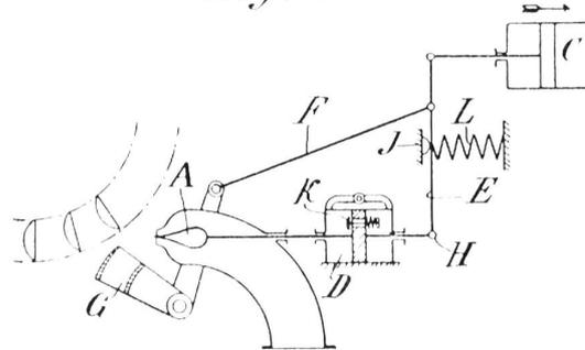
einen festen Anschlag *J* dreht, in Zusammenarbeit mit einer Feder *B* beziehungsweise *L* und einer die rasche Verkleinerung des Strahlquerschnittes verhindernden Ölbremse *D*.
