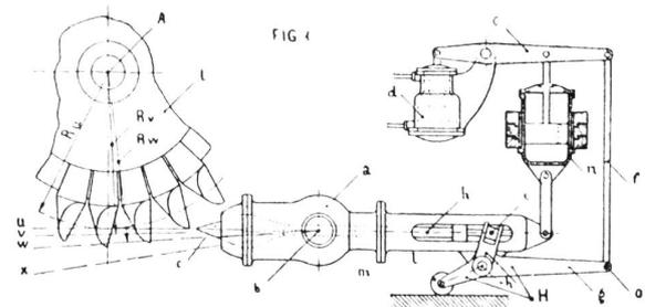
Wenn zum Beispiel infolge Entlastung der Turbine unter Einwirkung des Geschwindigkeitsreglers die Hilfsmaschine *d* den Doppelhebel *e* der Bewegung des Uhrzeigers entgegen-
