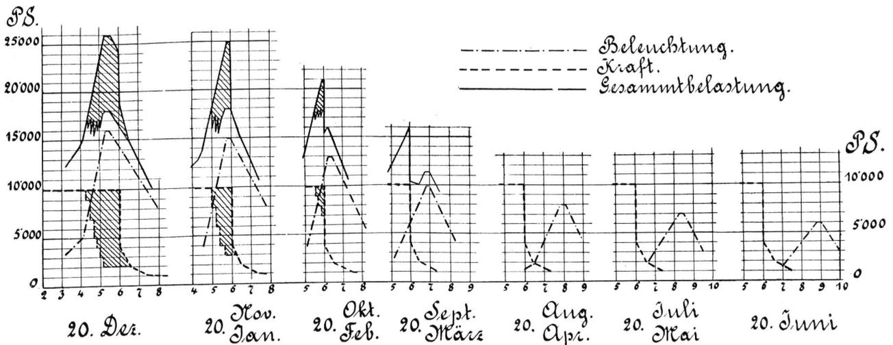
Abbildung 4. Diagramme der Belastungsspitzen.
