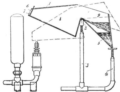
Wasser entnommen wurde, ist der Zufluss zum Anlassbehälter unterbrochen. Bleibt der Widder stehen, so steigt das Wasser im Reservoir und fliesst schliesslich wieder dem Anlassbehälter zu, worauf derselbe wieder in Tätigkeit tritt, und somit dem Stossventil sofort wieder der notwendige Impuls zur Weiter­arbeit des Widders gegeben wird.
