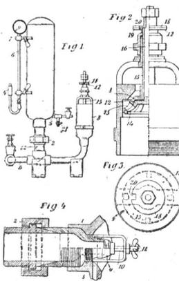
**Vorrichtung zur Regelung von Wasserturbinen.** Hauptpatent No. 57833. A.-G. der Maschinen-Fabriken Escher Wyss & Cie., Zürich.
