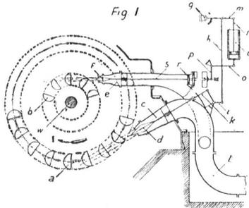
düse *c* mittelst der Nadel *d* und mittelst des Gestänges *m, n, o, p* einschliesslich des Kataraktes *q*, einer Hilfskraft­maschine *r* und der Stange *s* wird die Nadel *f* zurückgezogen und dadurch der Austritt der Hilfsdüse *e* geöffnet. Es strömt durch diesen Austritt Wasser auf das Bremsrad *b*, wodurch mittelst dieses Rades auf die Haupt­welle *w* ein Drehmoment ausgeübt wird, welches dem vom Haupt­rad auf die Welle *w* ausgeübten Drehmoment entgegengerichtet ist.
