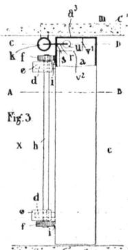
Wasserdruck in die Öffnung der Wand *v*<sup>1</sup> gedrückt und verhindert daher das Eindringen von Wasser in die Kammer *v*. Steigt nun der Oberwasserspiegel um einen den Abstand zwischen seiner Normalhöhe und dem tiefsten Punkt der
