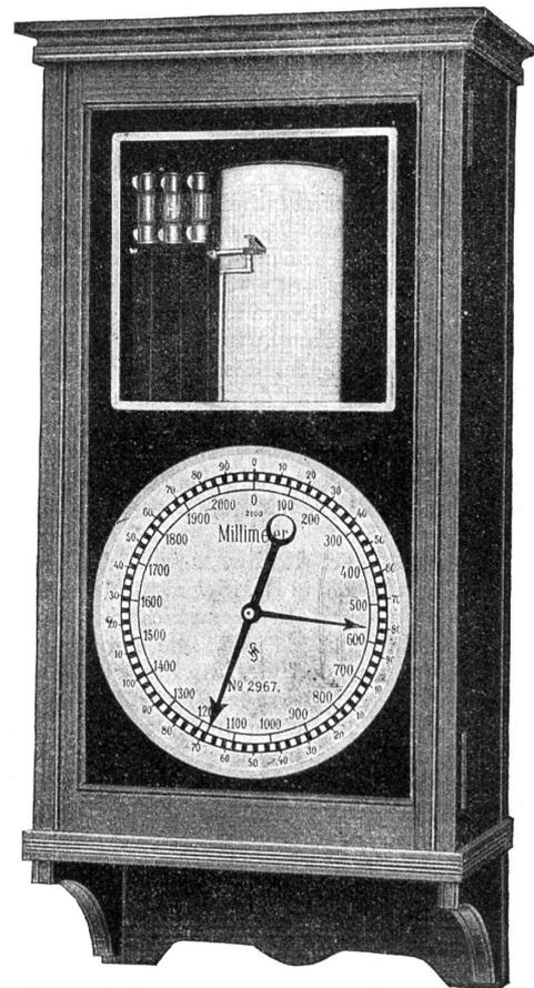
Abb. 3. Empfänger mit Zeiger und Registriervorrichtung.
