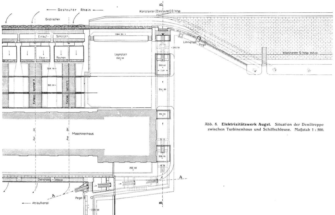
Abb. 8. Elektrizitätswerk Augst. Situation der Denitreppe zwischen Turbinenhaus und Schiffschleuse. Maßstab 1 : 500.
