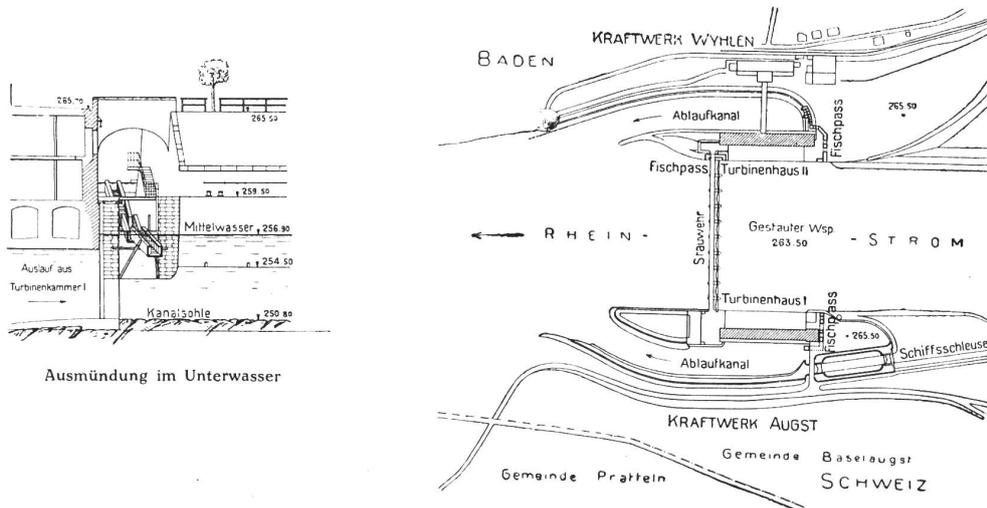
Abb. 7. Elektrizitätswerke Augst-Wyhlen. Situation der Anlage mit den 3 Fischtreppen. Maßstab 1 : 10000.
