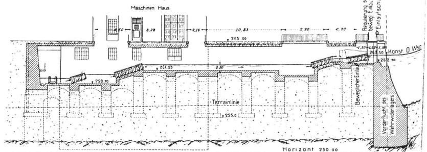
Abb. 9. Elektrizitätswerk Augst. Längsschnitt durch die Denitreppe. Maßstab 1 : 500.
