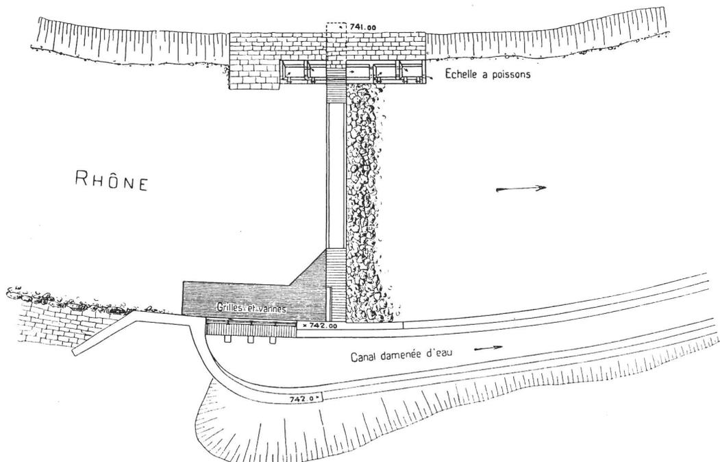
Abb. 82. Usine de M rel. Situation du Barrage. Echelle: 1 : 500.
