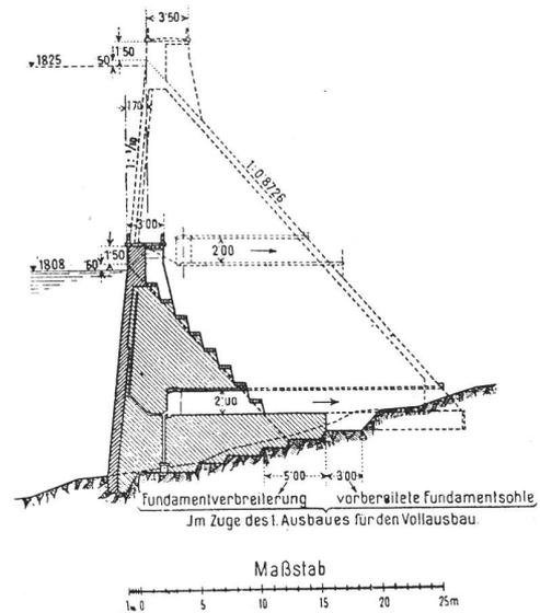
Abb. 3. Querschnitt durch die südliche Staumauer.
